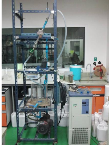
รูปที่ 4 โครงสร้างไฮโดรไซโคลนที่ใช้ในการทดลอง
